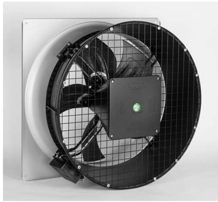
图 2：ebm-papst 的 AxiTop 扩散器可以大大改善能效和噪声。其增压作用最大限度减少了出口损耗，并且使针对市售热交换器对风机进行改动变得更为容易。
