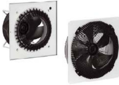
图 2: 导流栅显著降低了进气流中断产生的噪音, 对于轴流和离心风机都同样有效。对于功率输入和空气动力性能几乎没有影响。
